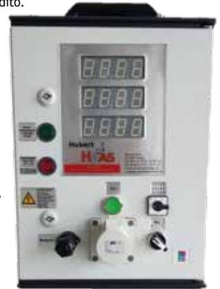
E' consigliabile associare allo storditore, uno stabilizzatore di tensione al fine di evitare che sbalzi di tensione sulla linea elettrica provochino danni allo strumento o errate letture dell'impedenza da parte dello stesso.
