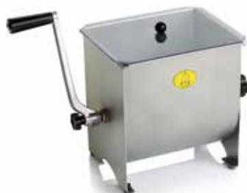
Impastatrice manuale con azionamento pala diretto. Struttura, carter, vasca, pala, albero interamente in acciaio inox AISI 304. Coperchio vasca in Lexan trasparente. Pala amovibile per agevolare le operazioni di smontaggio e pulizia.
