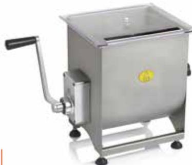
Impastatrice manuale con azionamento pala tramite riduttore. Struttura, carter, vasca, pala, albero interamente in acciaio inox AISI 304. Coperchio vasca in Lexan trasparente. Pala amovibile per agevolare le operazioni di smontaggio e pulizia.
